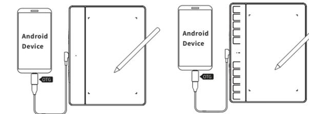
2. Abra o aplicativo de Android que suporta a detecção de pressão, por favor, coloque a mesa de XP-PEN e o dispositivo de Android na posição vertical.
